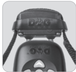
Postavenie pri zapínaní/vypínaní prijímača a pri škárovaní vysielača s prijímačom
