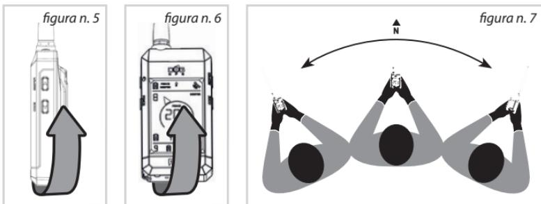
**ATTENZIONE:** La precisione della freccia di direzione (che punta al nord) dipende dalla corretta taratura della bussola elettronica. Calibrare di nuovo correttamente, quando l'indicazione della direzione del cane è imprecisa.
