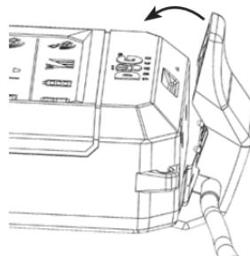
**WAGA:** Optymalna temperatura ładowania to od 0 °C do 40 °C. Używaj tylko oryginalnej przejściówka, dostarczanej wraz z urządzeniem. Inne ładowarki mogą uszkodzić akumulator.
