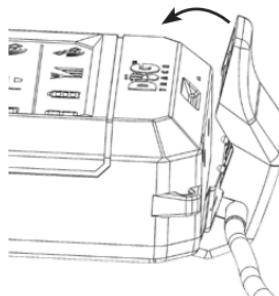
**AVERTISSEMENT:** Chargez la batterie dans un endroit avec une température de 0 °C à 40 °C. Utilisez l'adaptateur d'alimentation d'origine fourni par le fabricant pour le rechargement. Des dommages irréparables peuvent être causés à la batterie si vous utilisez d'autre adaptateur d'alimentation que celui d'origine.
