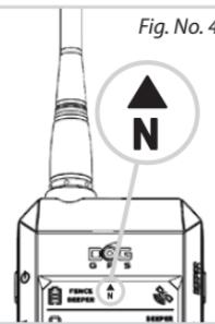
3. Toujours en direction du nord, effectuer au minimum 10 rotations selon les Figures No. 5 et No. 6). Pour un bon étalonnage, chaque rotation doit être effectuée avec un petit écart par rapport à la direction du nord (Fig. No. 7). Plus lentement et plus de tours que vous faites, plus l'étalonnage sera précis. Pour quitter, appuyez sur la touche "retour" ↲.
