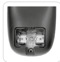
Oznaczenie biegunów baterii
