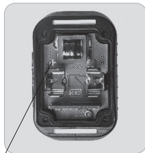
Oznaczenie biegunów baterii
